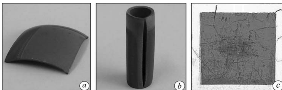
Рис. 1. Півкомірки (КПК без катодного шару) розміром 50 \times 50 \text{ mm}^2 після відпалу у повітрі (а) і водні (б) впродовж 50 h та повна комірка після тривалої експлуатації (с). Шар електроліту розташований з опуклого (а) та зовнішнього (б) боків відповідно.
