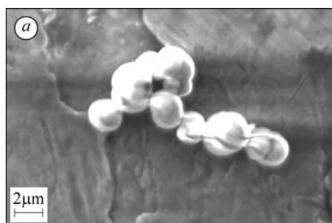
Рис. 7. Електронно-мікроскопічне зображення відкладень продуктів корозії на поверхні арматурної сталі (a, b) і результати мікрорентгено-спектрального аналізу (c).
