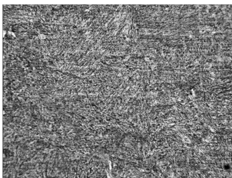
Рис. 1. Мікроструктура сталі 65Г ( W_{6/5} = 6^\circ\text{C/s} ); \times 500 .
