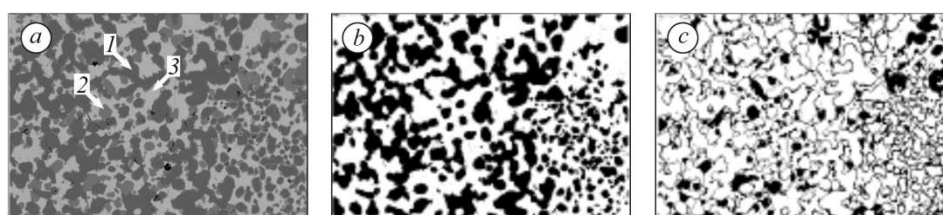
Рис. 1. Структура кермету \text{Cr}_3\text{C}_2 -МНМц 60-20-20 ( \times 500 ) та форма і характер розташування в ньому фаз: b – \text{Cr}_3\text{C}_2 ; c – (\text{Cr}, \text{Mn})_7\text{C}_3 ( b ); d – твердий розчин на основі Cu.
