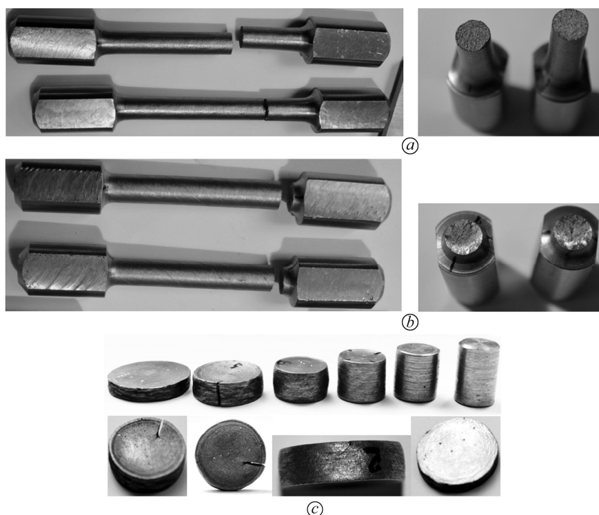
Рис. 2. Зразки із вольфрамового сплаву типу ВНЗ після випробовувань на розтяг ( a ), кручення ( b ), стиск ( c ).
