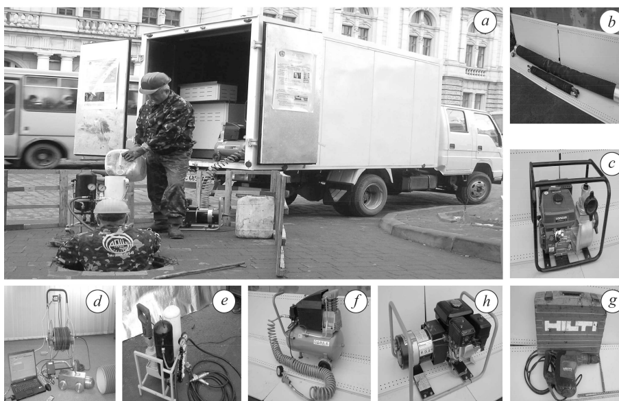
Рис. 9. Мобільний діагностично-відновлювальний комплекс з його інструментальним наповненням.
