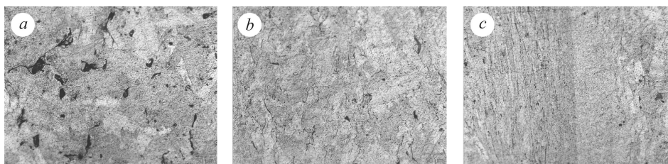
Рис. 2. Мікроструктура зварного з'єднання спеченого титану BT1-0: a – основний метал; b – зона термомеханічного впливу поблизу основного металу; c – зона зварного шва та термомеханічного впливу поблизу нього.
