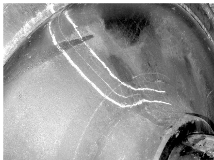
Рис. 1. Радіальна тріщина в залізничному колесі [3].
