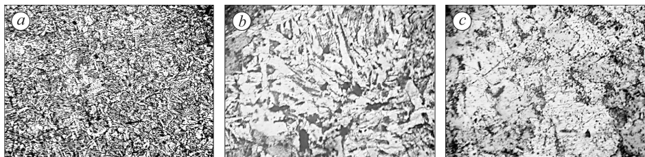
Рис. 3. Структура експлуатованої арматурної сталі (a), зони термічного впливу на ділянці перегріву (b) та металу шва між двома торцями прутків арматури (c). \times 250 .
