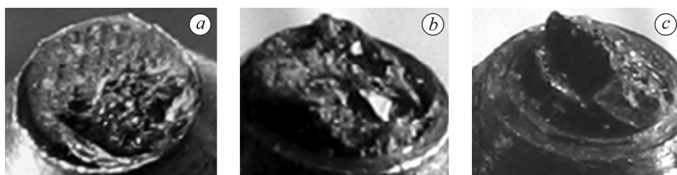
Рис. 3. Зруйновані поверхні кристалів електрокорунду нормального алмазним олівцем: a - субмікроруйнування зерна, h = 0,005 mm; b - мікроруйнування зерна, h = 0,02 mm; c - макроруйнування зерна, h = 0,05 mm ( \times 20 ).
