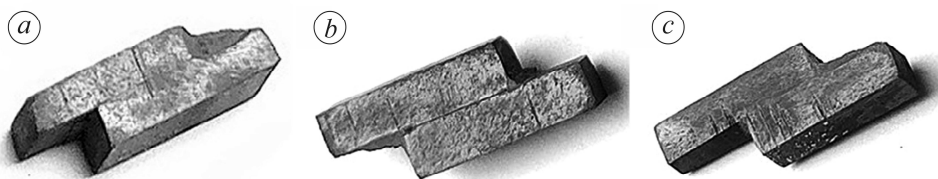
Рис. 3. Зовнішній вигляд паяних зразків після нагрівання ( T = 900^\circ\text{C} ; t = 67 h), отриманих зі застосуванням припоїв: a – № 1; b – № 2; c – № 4.
