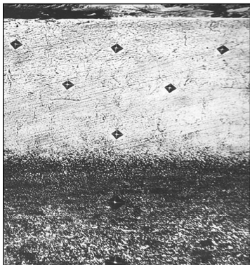
Рис. 2. Мікроструктура сталі 65Г після МПО в мінеральній оліві ( \times 400 ).
