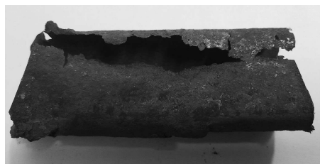
Рис. 1. Пошкодження колтюбінгової труби зі сталі HT-95 після експлуатації у свердловині.
