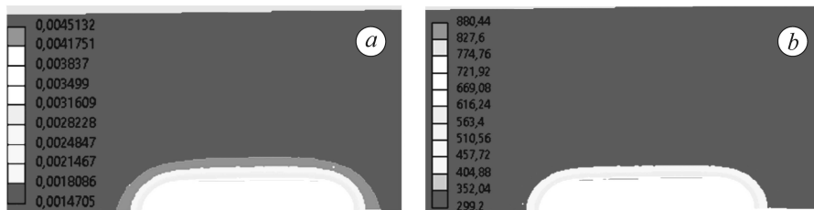
Рис. 2. Розподіл еквівалентних деформацій (а) та напружень (b) в околі еліптичної тріщини.
