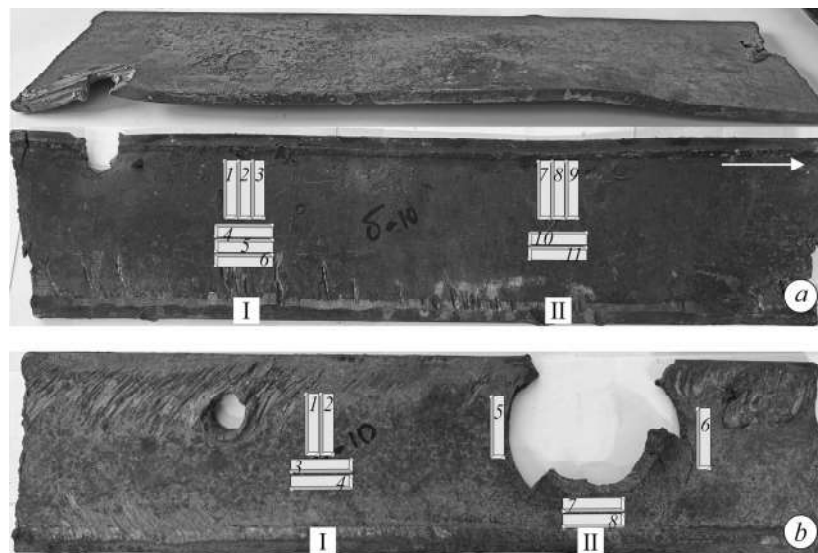
Рис. 2. Схема вирізання поздовжніх і поперечних до напрямку вальцювання (вказано стрілкою) зразків Шарпі з ділянок A (а) та B (б) на віддалі (I) та поблизу (II) екстремального деформаційного впливу.
