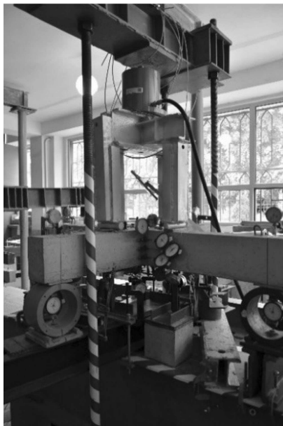
Рис. 4. Установка для дослідження балки ЛП-1.
