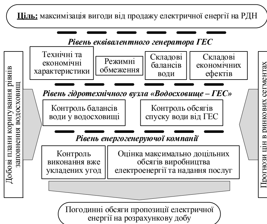
Рис. 1. Архітектура моделі оптимального розподілу гідроресурсів для виробництва електроенергії на гребельній ГЕС
