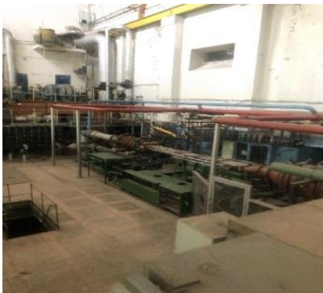
Рис. 3. Вигляд МГД-установки К-1 (на передньому плані – фальш-канал з трактом продуктів згоряння, на задньому – відцентровий повітряний компресор К-500)
