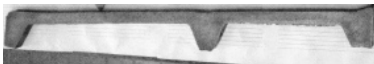
Рис. 8. Макроструктура отливки в продольном разрезе (повернуто на 90^\circ )
