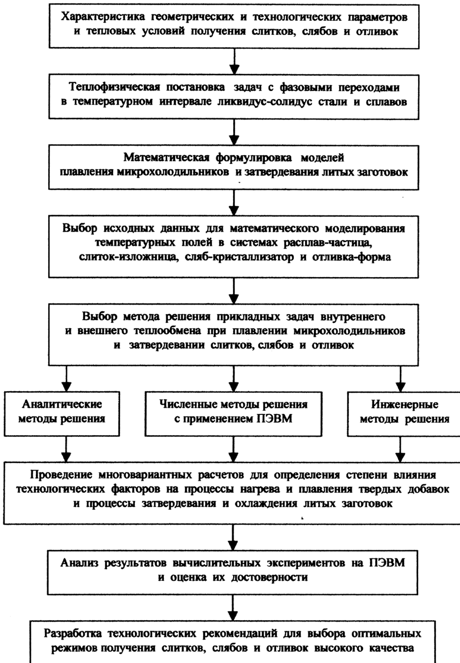
Рис. 1. Принципиальная схема математического моделирования тепловых процессов при получении слитков, слябов и отливок
