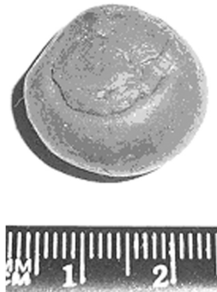
Рис. 3. Форма отливки после стягивания “хвоста” ( Fr = 2,5 )
