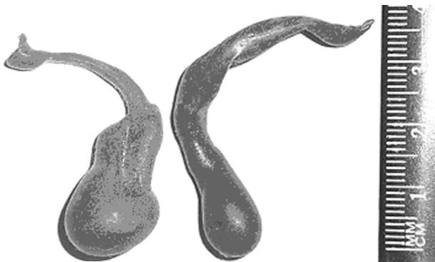
Рис. 4. Форма отливок при втекании кормовой части объема сплава в сфероидизирующийся объем сплава ( Fr > 2,5 )
