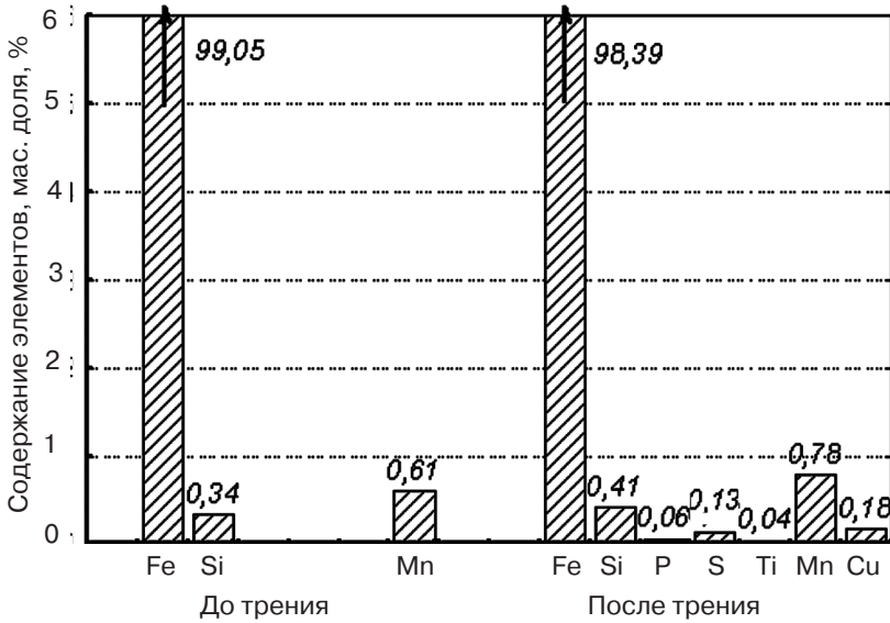
Рис. 7. Микрохимический анализ поверхностей трения при граничном трении до и после изнашивания при нагрузке 200 кг/см 2 : а – сплав С4CuS+Ti литой; б – контртело Ст5 зак
