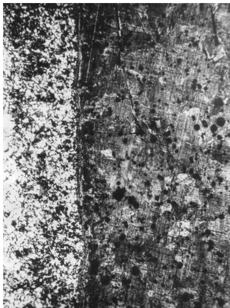
Рис. 5. Структура переходного слоя биметаллического лемеха
