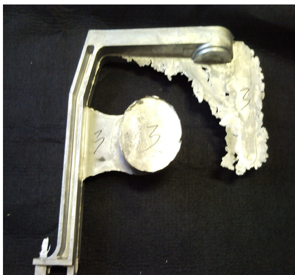
Рис. 1. Отливка «кронштейн», масса куста 1,2 кг, получена на машине 711А09 из частично закристаллизованного алюминиевого сплава АК7ч
