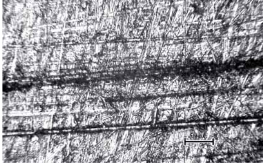
Рис. 1. Структура поверхности контртела стали марки Ст5 зак до испытания на трение
