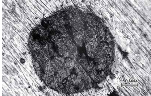
Рис. 5. Структура поверхности контртела стали марки Ст5 зак после испытания на трение в паре с литым сплавом С4СuS + TiN при нагрузке 200 кг/см 2 , время испытания 180 мин
