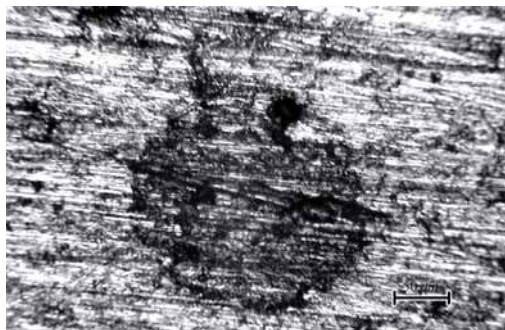
Рис. 17. Структура поверхности отожженного сплава \text{С4CuS} + \text{AlN} после трения в масле с контртелом из стали марки \text{Ст5}_{\text{зак}} при нагрузке 200 \text{ кг/см}^2 , время испытания 9 ч
