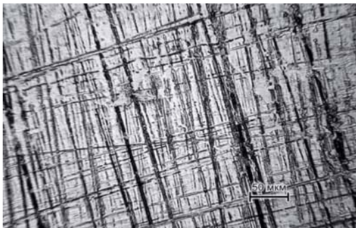
Рис. 2. Структура поверхности контртела стали марки Ст5 зак после испытания на трение в паре с литым сплавом С4CuS + TiN при нагрузке 200 кг/см 2 , время испытания 10 мин
