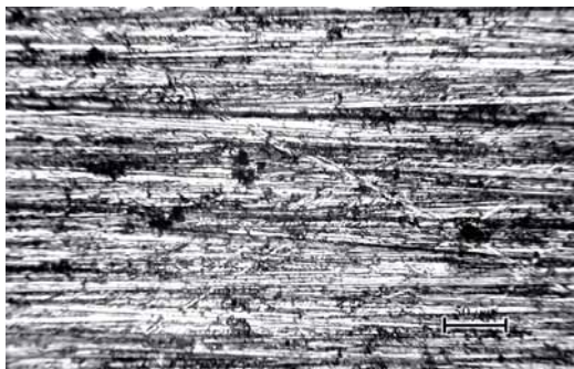
Рис. 18. Структура поверхности контртела из стали марки \text{Ст5}_{\text{зак}} после трения в масле с отожженным сплавом \text{С4CuS} + \text{AlN} при нагрузке 200 \text{ кг/см}^2 , время испытания 9 ч
