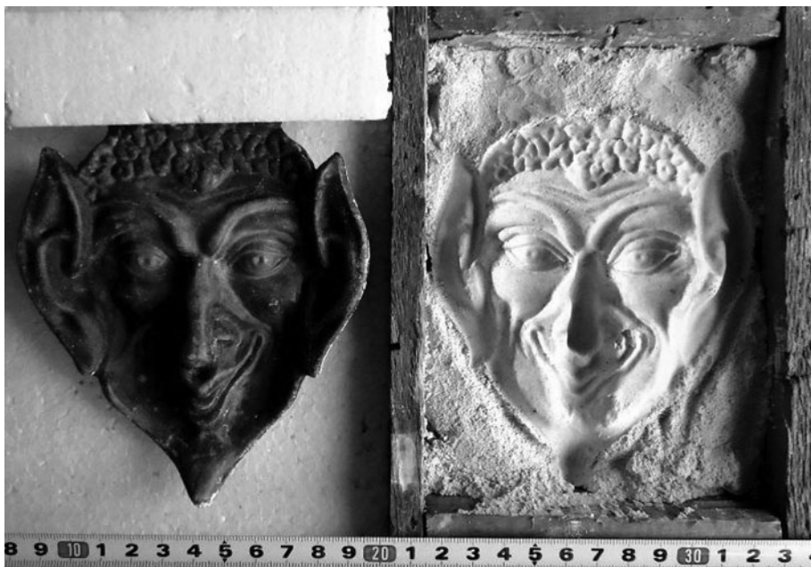
Рис. 2. Металлическая художественная модель и полученная по ней полуформа
