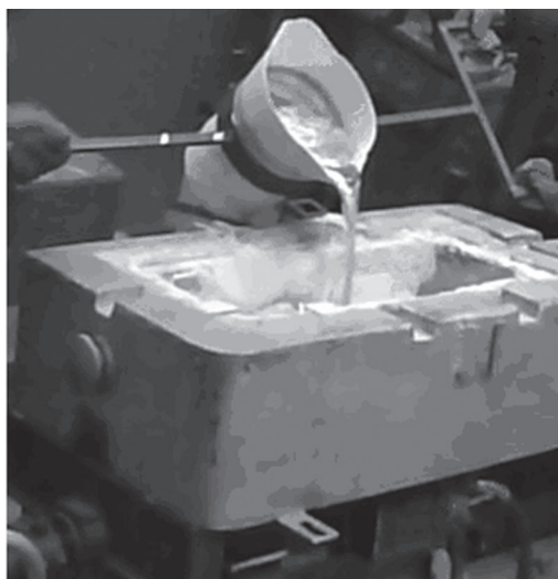
Рис. 1 Заливка жидкого металла из ковша в тигель макета двухзонной магнитодинамической установки
