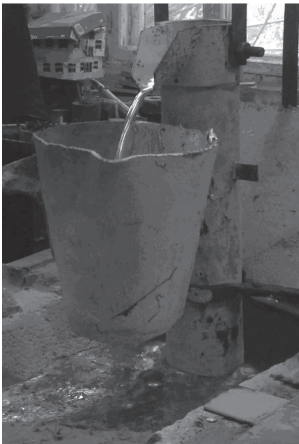
Рис. 2. Заполнение мерного ковша расплавом из металлопровода при определении расходных характеристик
