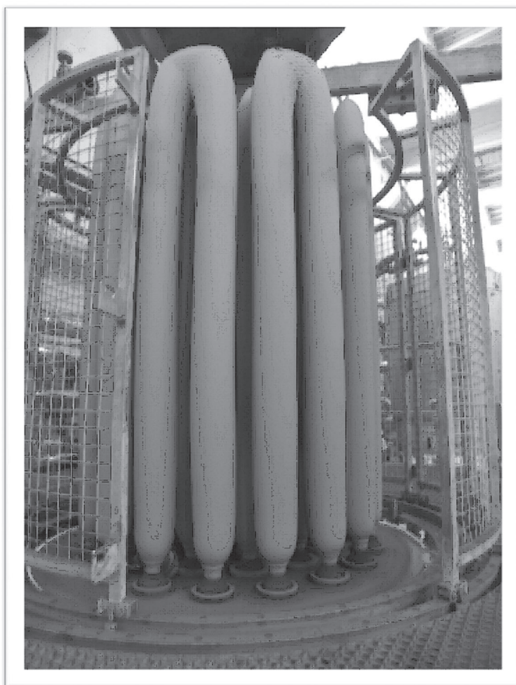
Рис. 6. Общий вид стержней поликристаллического кремния после вскрытия реактора водородного восстановления трихлорсилана
