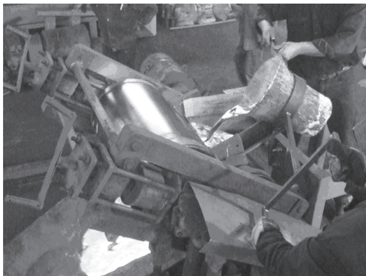
Рис. 2. Заливка металла в установку
