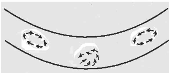
Рис. 3. Схема циркуляции одиночных частиц влево-вправо по замкнутым орбитам при скоростях ниже 8 см/с
