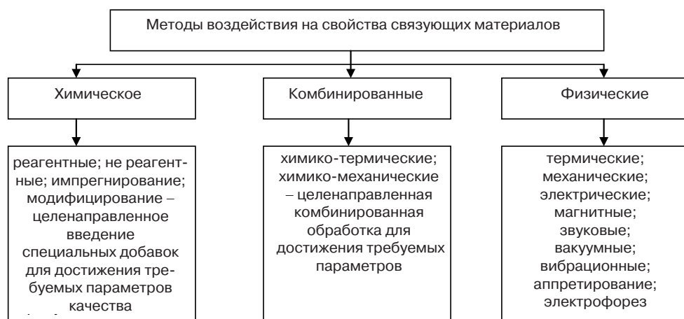
Рис. 2. Классификация способов повышения связующей способности связующих материалов
