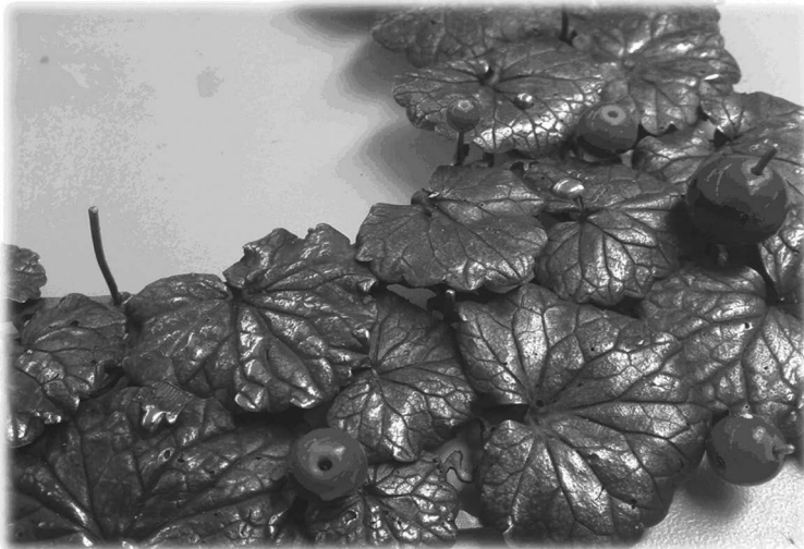
Рис. 14. Полировка и штифтовая закрепка декоративных элементов
