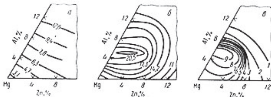
Рис. 1. Влияние элементов на механические свойства сплавов системы Mg–Al–Zn в литом состоянии [1]: а – \sigma_{0,1} ; б – \sigma_b кгс/мм 2 ; в – \delta , %
