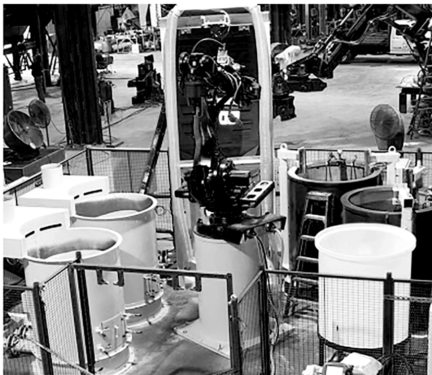
Рис. 6. Роботизована дільниця виготовлення піщаних оболонок за моделями, що виплавляються
