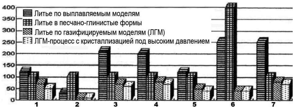
Рис. 6. Сравнительные технико-экономические характеристики методов получения сложнофасонных отливок: 1 – потребление шихтовых материалов; 2 – потребление формовочных и стержневых материалов; 3 – потребление электроэнергии; 4 – потребление газа; 5 общие затраты; 6 – затраты на основные технологические площади; 7 – себестоимость
