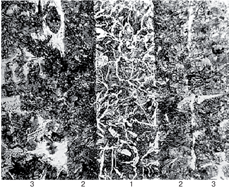
Рис. 1. Мікроструктура двошарового виливку з чавуну з діафрагмою зі сталеві пластиною Ст3 товщиною 0,7 мм: 1 – діафрагма; 2 – перехідний шар; 3 – чавун
