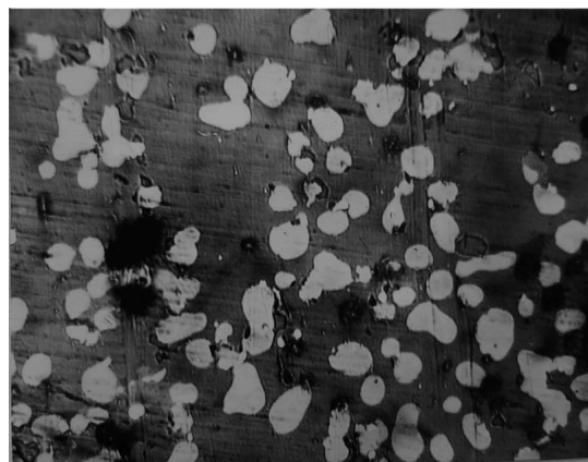
Рис. 6. Мікроструктура малофосфористого шлаку з зовнішньої частини гарнісажу (світло відбите); x 200
