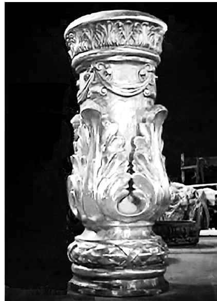
Рис. 2. Чавунна декоративна частина колони і деталь, вилита за друкованою моделлю
