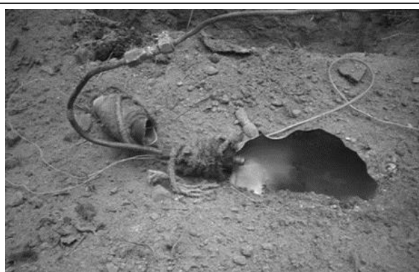
Рис. 7. Фото гидридного патрона после взрыва
