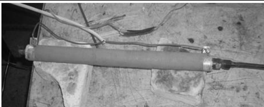
Рис. 1. Фото гидридного патрона в процессе подготовки к эксперименту
