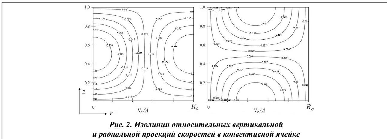
**Рис. 2. Изолинии относительных вертикальной и радиальной проекций скоростей в конвективной ячейке**
