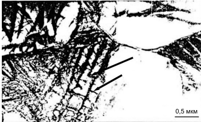
Рис. 5. Утворення стійких смуг ковзання (указано стрілками) в \alpha -пластинах бімодальної мікроструктури сплаву VT3-1.
