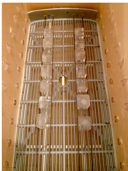
Рис. 1. Фотография рабочей камеры модели печи и устройства для создания пульсаций.
