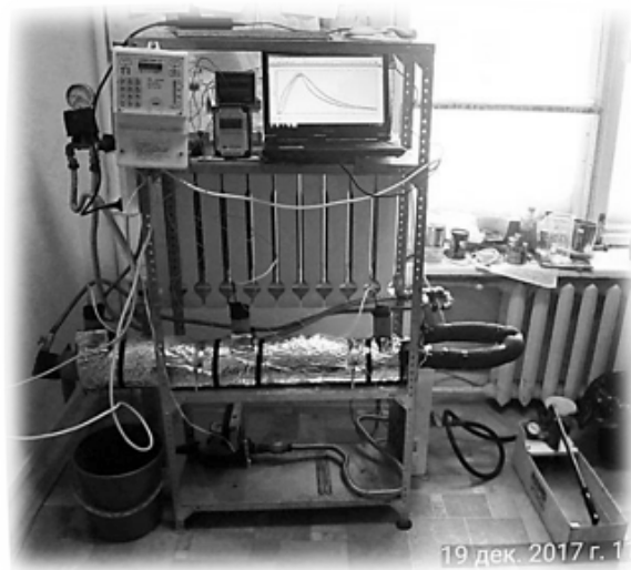
Рис. 2. Загальний вигляд та тепла схема експериментального стенду.
