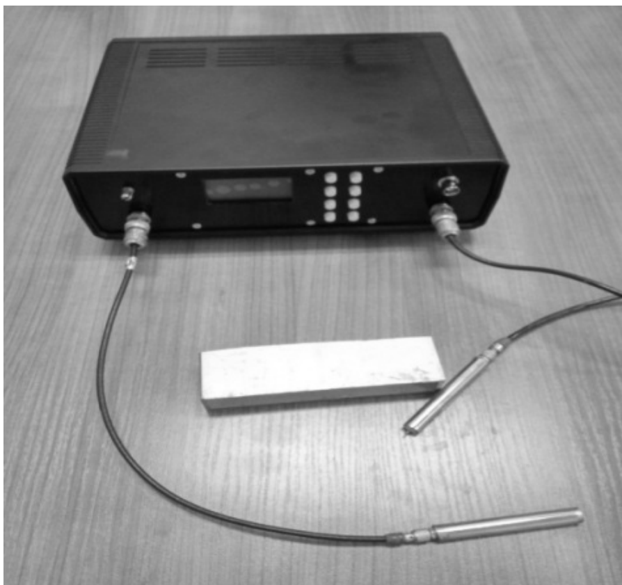
Рис. 2. Електронний блок з підключеними малоапертурними магнітострикційними перетворювачами.
