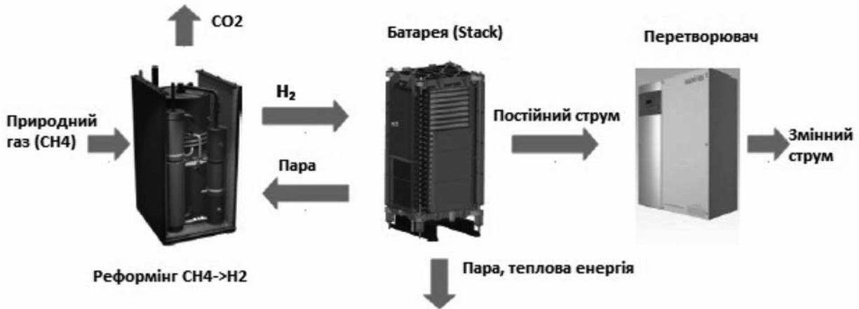
Рис. 2. Технологічна блок-схема функціонування MCFC-технологічної установки на природному газі
