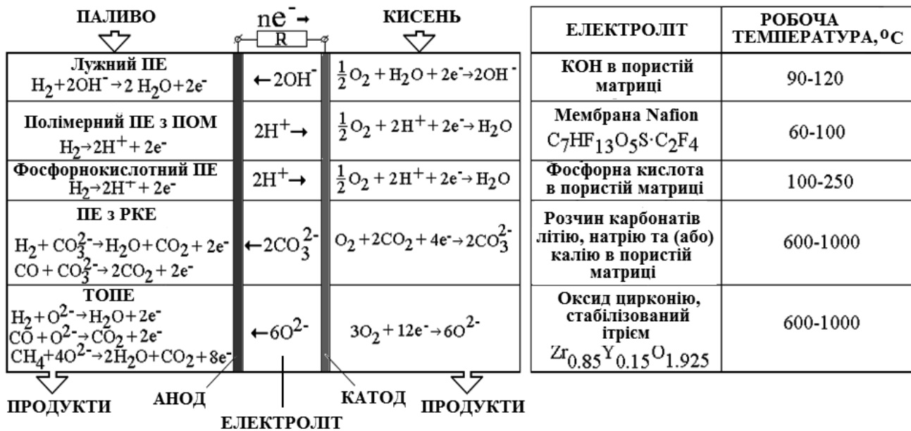
Рис. 1. Принцип дії паливних елементів
