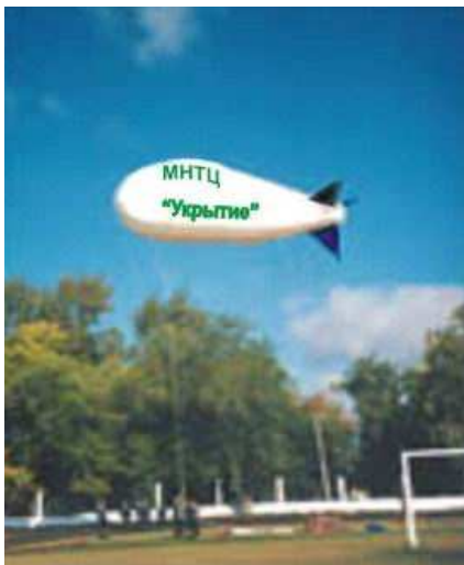
Рис. 6. Высотные измерения МЭД на промплощадке объекта «Укрытие» при помощи аэростата в 2003 г.
