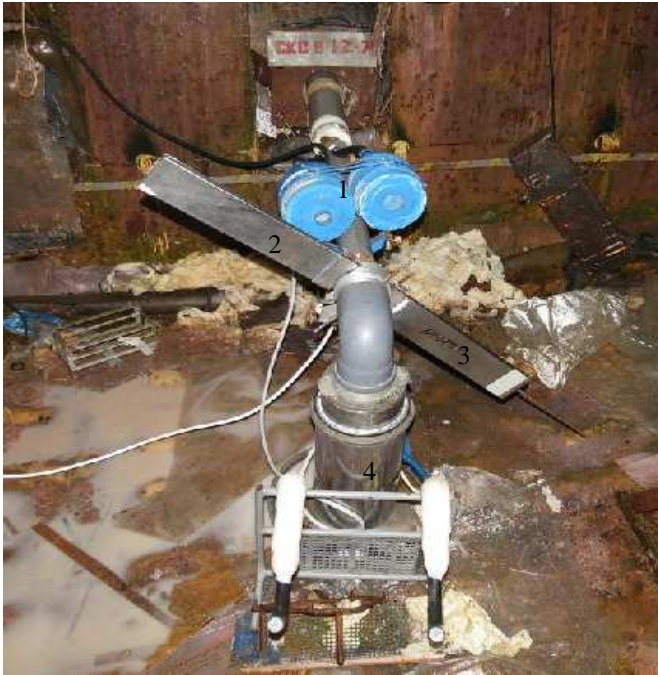
Рис. 1. Оборудование для отбора проб пыли: 1 - турбины УОПП; 2 - подающая кассета; 3 - приемная кассета; 4 - побудитель ВИ.
