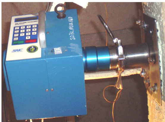
Рис. 3. Отбор пробы аэрозолей воздуходувкой Н810 SAIC в системе «Байпас».
