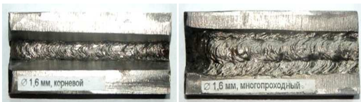
Рис. 2. Внешний вид сварных швов при мокрой подводной сварке высоколегированной коррозионностойкой стали типа 18-10.
